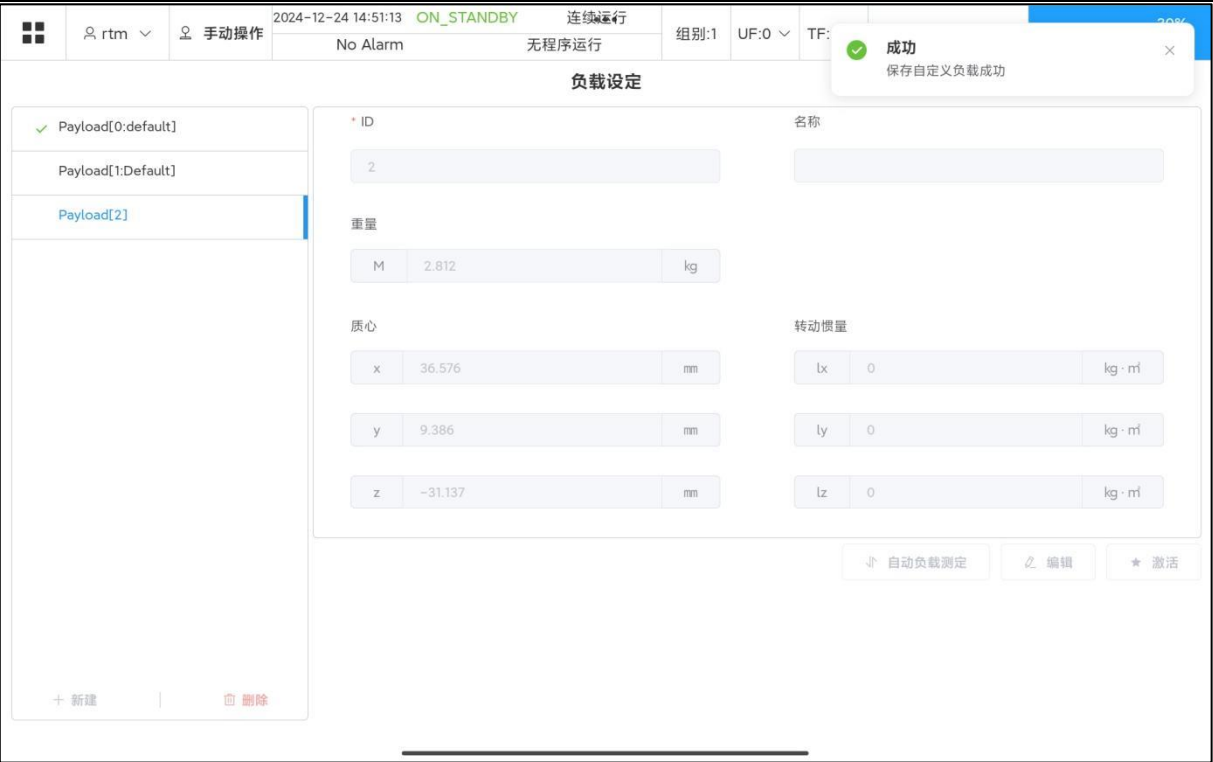
图 4.18 自动测定完成后的负载设定主界面
